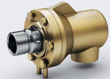
Universal-Drehdurchführung mit wartungsfreien Gleitlagern und Dichtring aus Kunstkohle. Metallimprägnierter Dichtring für Wärmeträgeröl und für hohe Druckbelastung bei Heißwasser und Dampf. Eingebautes Vakuumventil bei H3 für Dampfzylinder. Große Anzahl unterschiedlicher Ausführungen.
