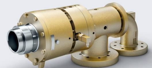
Drehdurchführung für Heißwasser und Dampf bei hohen Drücken und Drehzahlen. Entlastete Gleitringdichtung mit externer Wasserkühlung. Erfüllt die speziellen Anforderungen von Papier- und Vlieskalandern, Faser und Wellpappenanlagen. Geeignet für große, dampfbeheizte Trockner. Patentiertes System.
