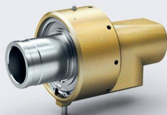
Universal-Drehdurchführung für Wasser, ausgerüstet mit Gleitringdichtung und Wälzlagern. DXS mit hochresistenter, keramikbeschichteter Dichtfläche für höhere Temperaturen und Drehzahlen sowie längere Standzeit.
