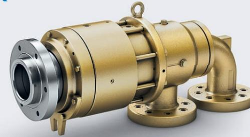
Drehdurchführung für Wärmeträgeröl mit hohen Temperatur- und Drehzahlbereichen, entlastete Gleitringdichtung. DQ, DQT, DQTX mit zusätzlichem Kühlkreislauf zur Kühlung und Schmierung von Lagern und Dichtung. Erfüllt die Anforderungen von schnell laufenden Kalandern. Patentiertes System.
