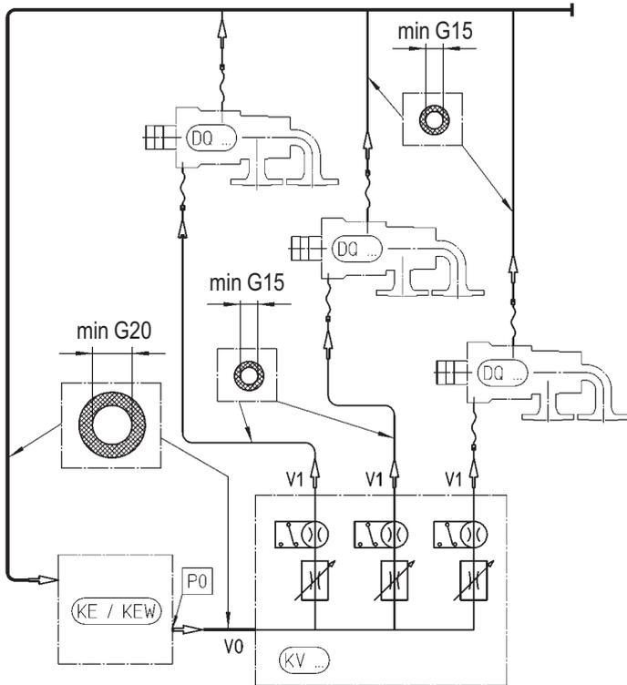
Применение двух и более ротационных соединений вместе возможно согласно рис. Распределитель KV позволяет избежать разницы в параметрах подачи, которые могут возникнуть из-за разной длины и сечения трубопроводов. Распределитель гарантирует нормальную подачу V1 к каждому ротационному соединению и выдает сигнал если данная подача не обеспечивается.
